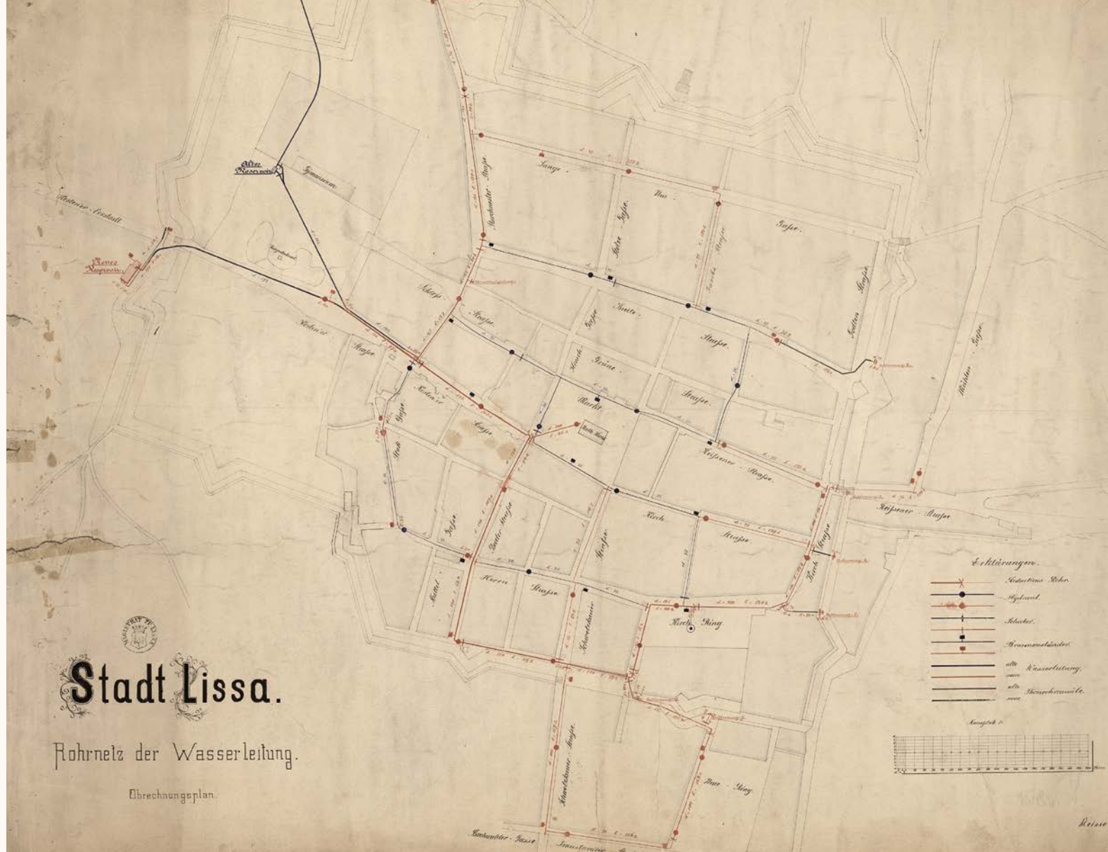
Plan sytuacyjny Leszna z rozmieszczeniem ujęć i zbiorników wyrównawczych wody oraz sieci wodociągowej (1878 r.)
